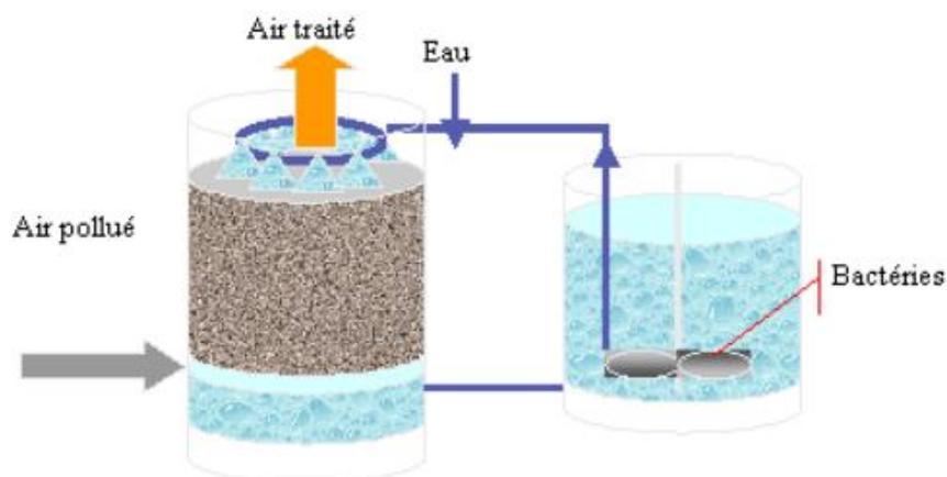
**Figure 17: Principe d'un biolaveur. Source : [www2.ademe.fr](http://www2.ademe.fr)**
