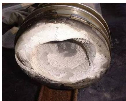
**Figure 25: Effet d'usure des siloxanes sur un moteur. (Source : Clarke Energy)**
