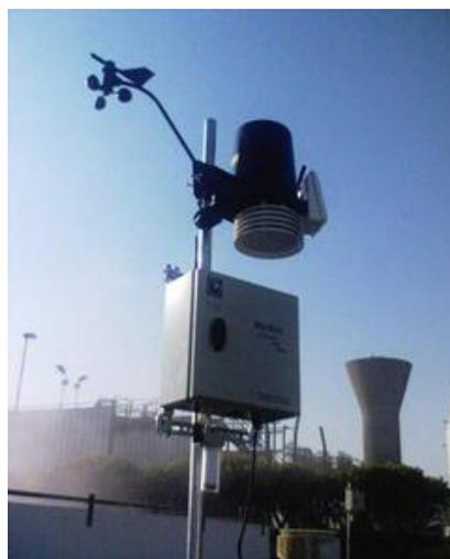
**Figure 22: Exemple de nez électronique fixe installé en périphérie d'une zone odorante. Source : Alpha-Mos**
