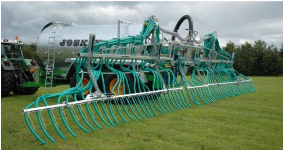
**Figure 29: rampe à pendillards (Source : Joskin)**
